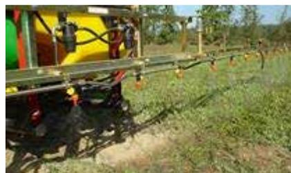
Estes equipamentos são, em geral, utilizados em culturas baixas sendo frequentemente usados para a aplicação de herbicidas, destinados a controlar o desenvolvimento de plantas indesejadas (infestantes). Na figura abaixo apresenta-se um exemplo de um pulverizador com barras horizontais.
